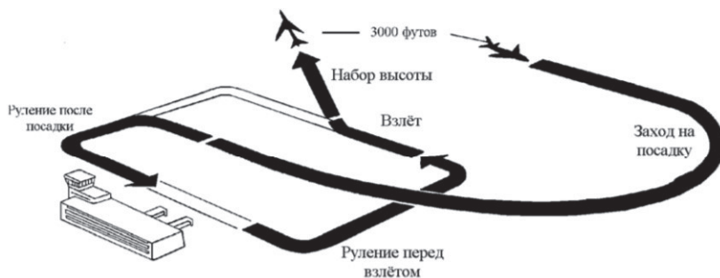
Рис. 2. Схема движения воздушного судна во время стандартного взлетно-посадочного цикла [4].
