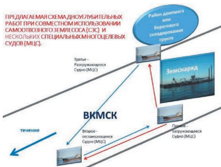
Рис. 11. Схема предусматривает вывоз спецсудами извлеченного из ложа канала грунта либо на свал глубин, либо на сушу, на специально отведенные места (карты намыва).
