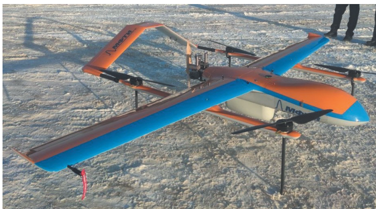
Рис. 1. Беспилотный летательный аппарат с локатором бокового обзора на борту, предназначенный для получения радиолокационной картины льда на расстояниях до 100 км от места взлета. Комплекс эксплуатируется с борта ледокола.
