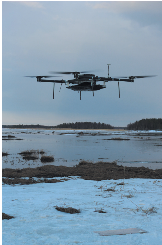
Рис. 3. Испытания георадара производства компании «Терразонд», установленного на борту БПЛА «Ирбис» в мае 2023 года на акватории Белого моря.
