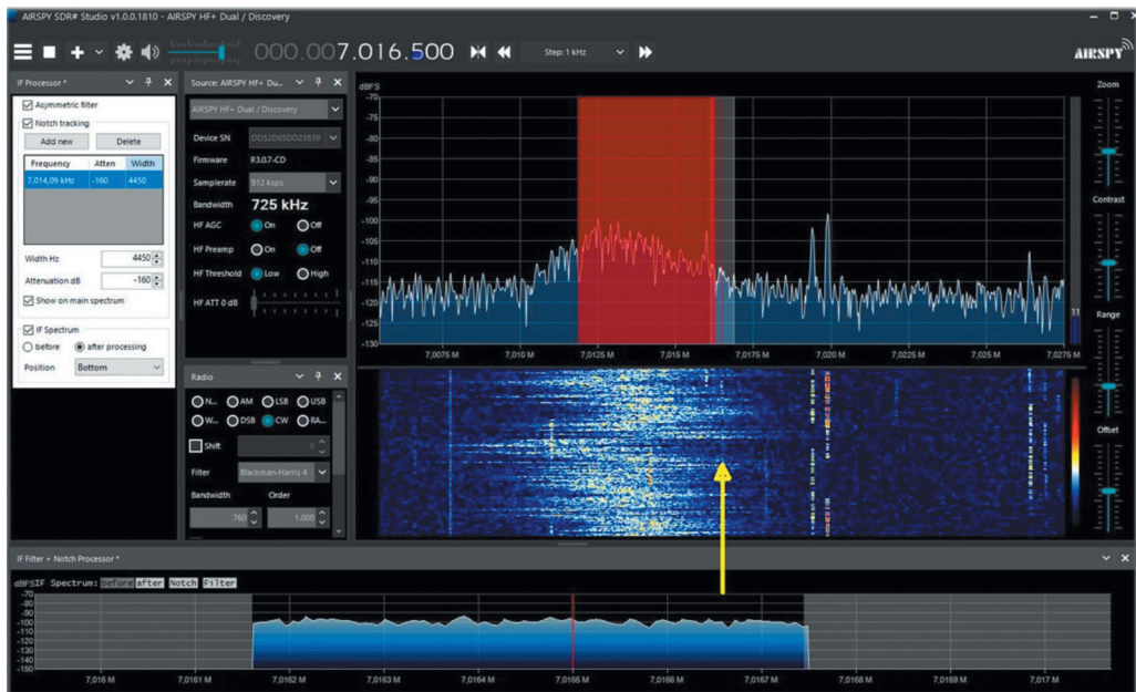
Рис. 5. Интерфейс ПО «Sdrsharp», предназначенного для обработки сигнала радиозонда, получаемого при помощи радиосканера RTL-SDR.
