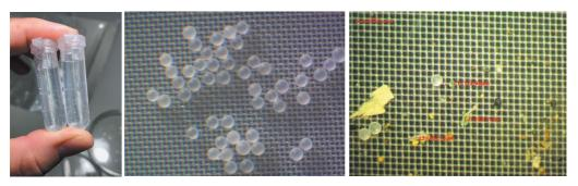
Рис. 2. Контрольные полистироловые гранулы в пробирках перед добавлением в образец грунта и на нейлоновом фильтре под микроскопом (в лаборатории ПластикЛаб), в том числе в высушенном природном образце (справа), размер ячейки фильтра 82 мкм.
