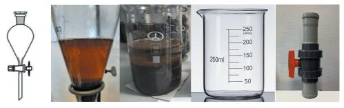
Рис. 1. Лабораторная посуда, используемая в эксперименте в лаборатории ПластикЛаб РГГМУ, с исследуемым образцом грунта в насыщенном растворе ZnCl<sub>2</sub>: делительная воронка (слева) и химический термостакан (в центре). Справа — SMI-установка согласно [21], используемая в лаборатории ИНОЗ РАН — СПБ ФИЦ РАН.
