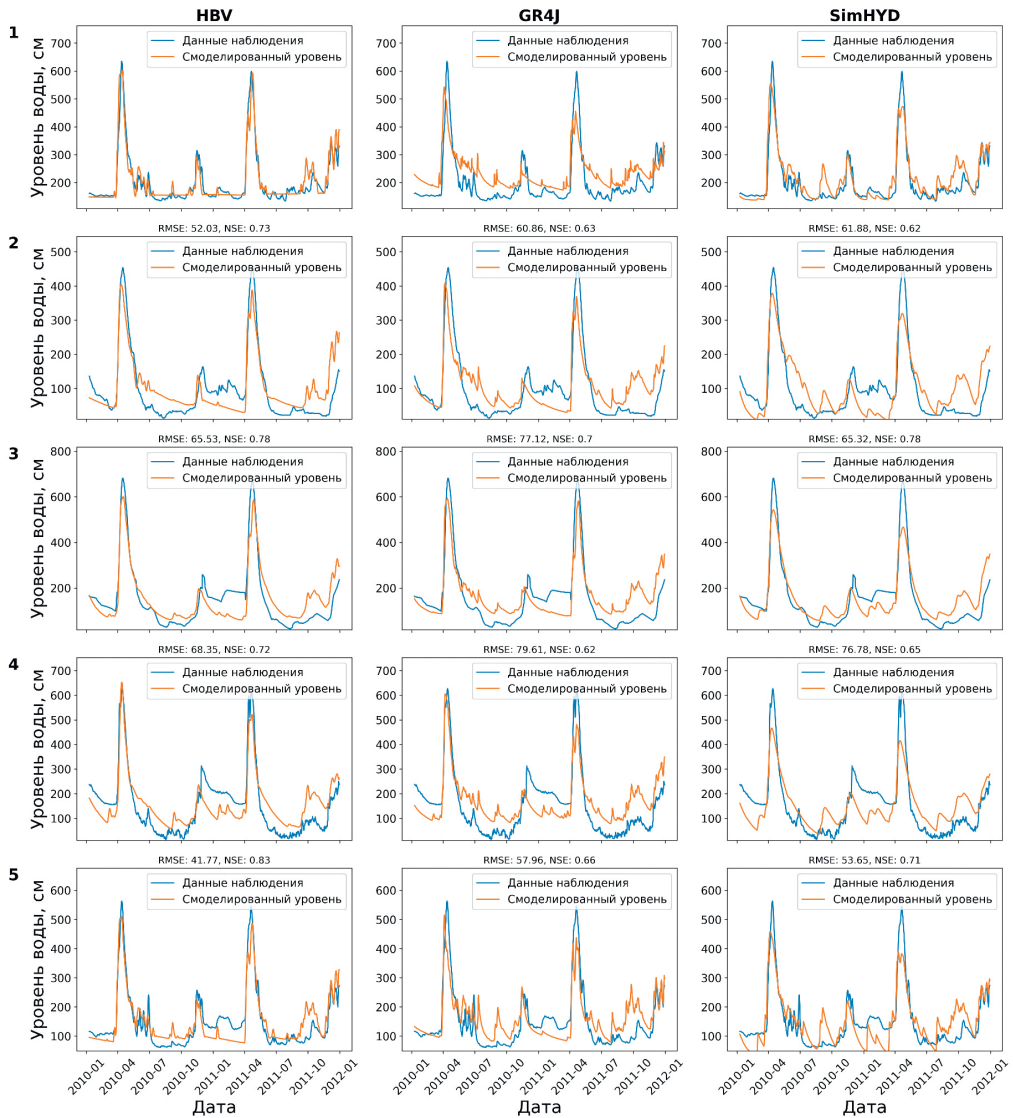
Рис. 5. Смоделированные и наблюдаемые уровни воды для основных гидрологических створов на реках Ленинградской области (за период с 2010 г. по 2012 г.):
