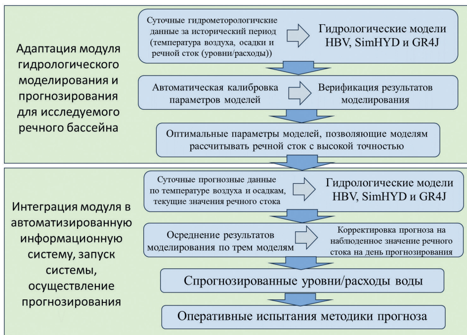
Рис. 3. Схематическое описание методики краткосрочного прогнозирования расходов/уровней воды.
