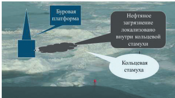
Рис. 6. Использование природных факторов при защите морской акватории от возможных аварийных нефтяных разливов в ледовый период.
