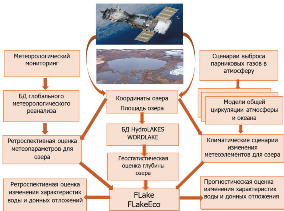
Рис. 2. Схема ретроспективной и прогностической оценки характеристик неизученных озер с использованием методов дистанционного зондирования и математического моделирования.
