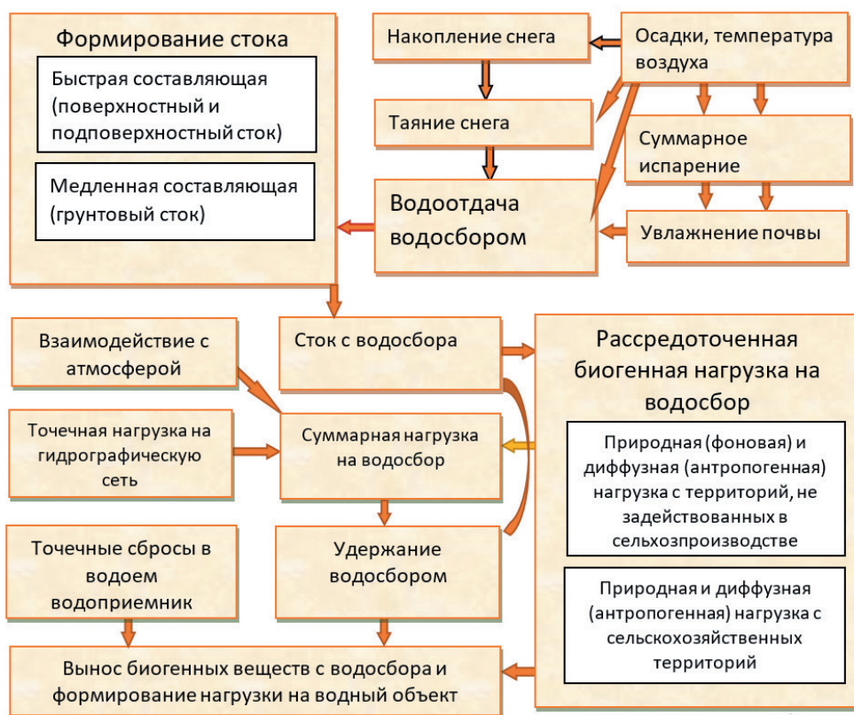
Рис. 13. Схема модели формирования стока с водосбора Онежского озера, выноса биогенных элементов и биогенной нагрузки на водные объекты.
