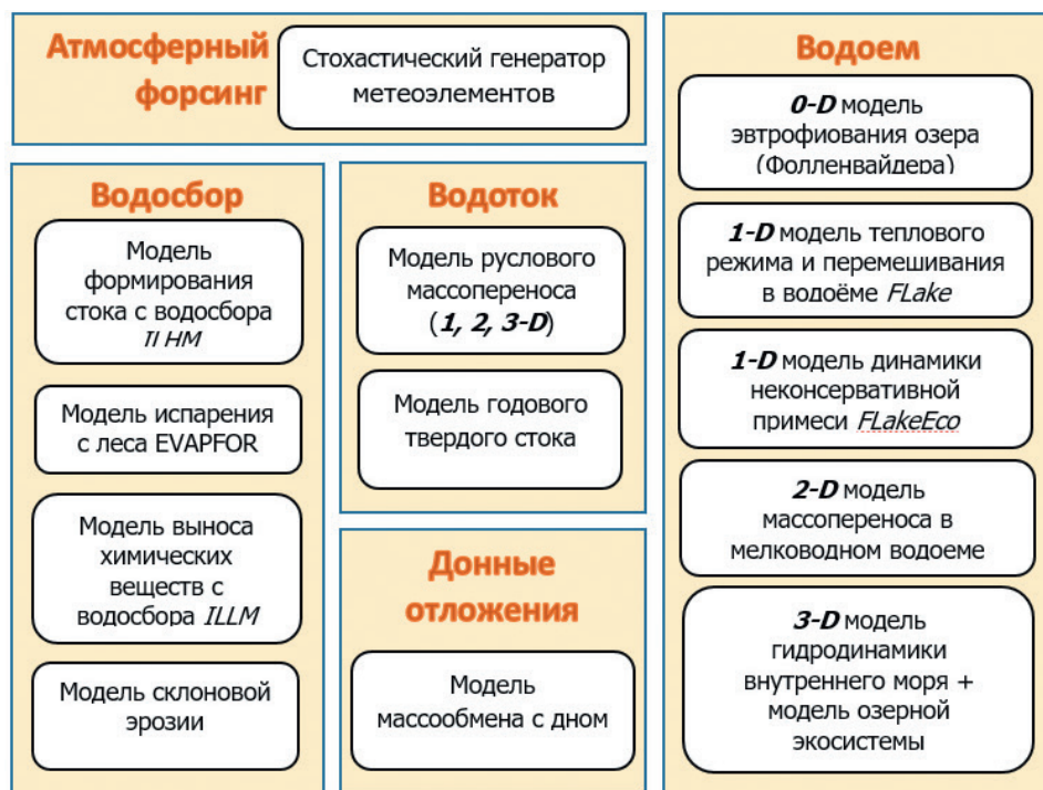
Рис. 1. Основные компоненты модельной системы Института озераведения РАН, описывающей тепло-массоперенос в системе «водосбор—водоток—водоем».
