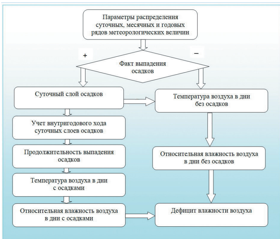
Рис. 15. Схема стохастического генератора метеоэлементов (стохастической модели погоды) [8].
