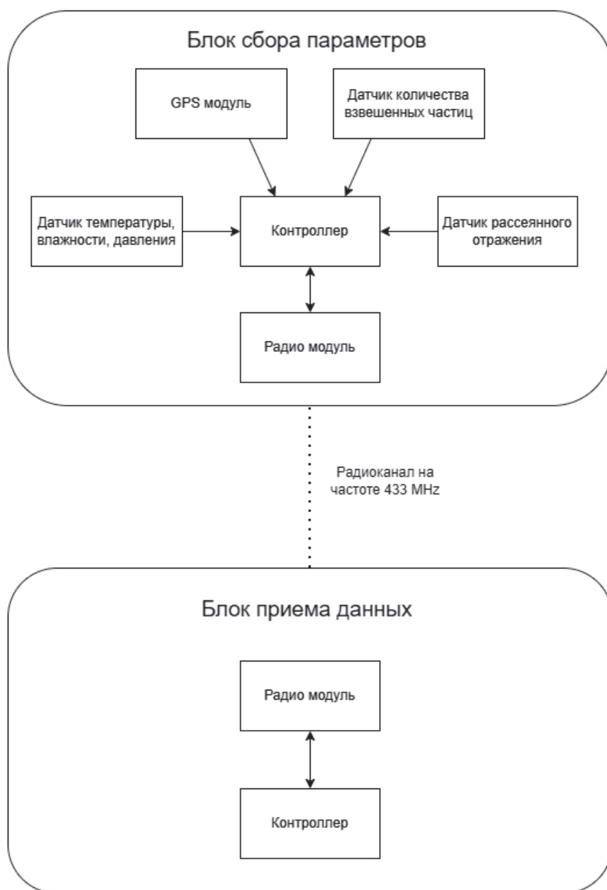
Рис. 1. Блок—схема измерительного комплекса параметров тумана.
