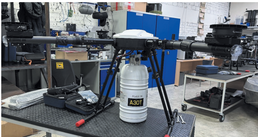
Рис. 6. БПЛА с установленным малогабаритным ГМЧЛ.
