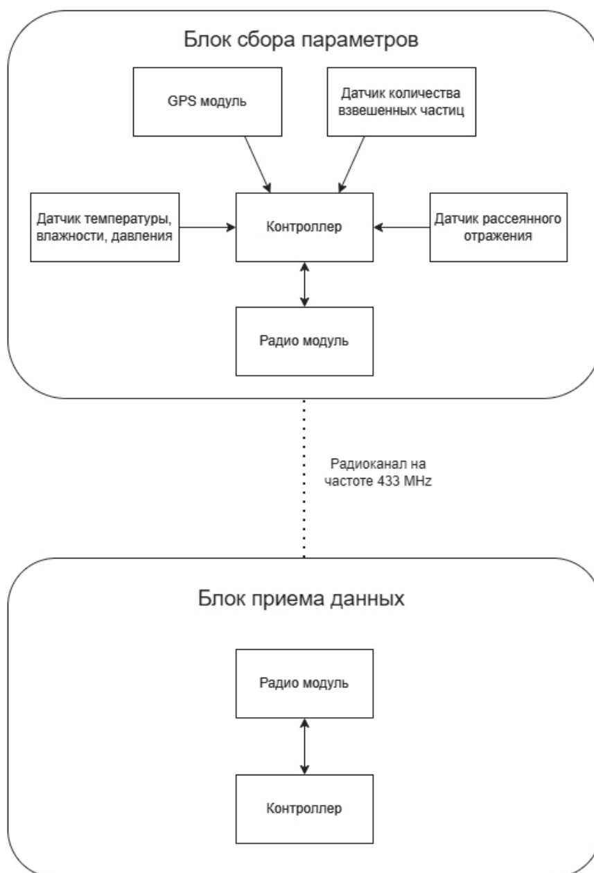
Рис. 1. Блок—схема измерительного комплекса параметров тумана.
