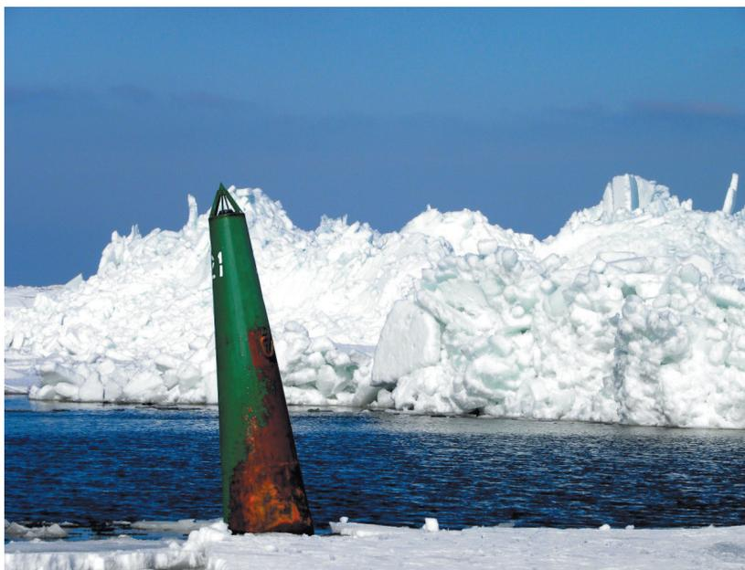
Рис. 3. Стамуха, образовавшаяся в ложе канала. На переднем плане «сигара» — зимний навигационный буй, обозначающий фарватер (фото: ФГБУ «АМП Каспийского моря»).
