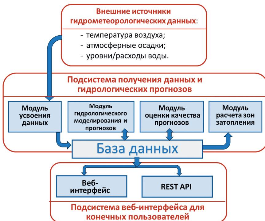
Рис. 1. Общая схема функциональных частей и потоков данных в АИС.
