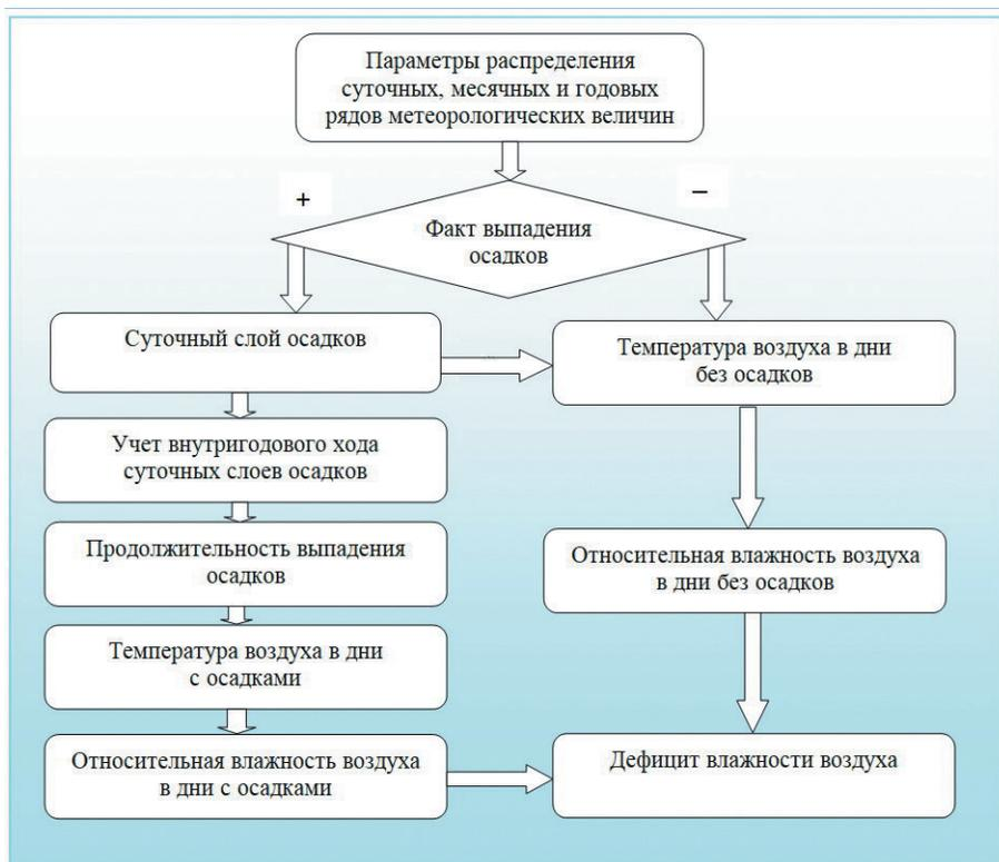
Рис. 15. Схема стохастического генератора метеоэлементов (стохастической модели погоды) [8].
