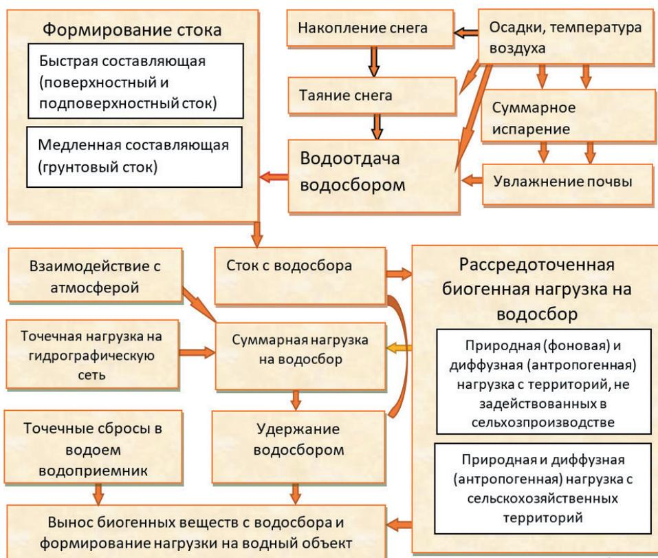
Рис. 13. Схема модели формирования стока с водосбора Онежского озера, выноса биогенных элементов и биогенной нагрузки на водные объекты.
